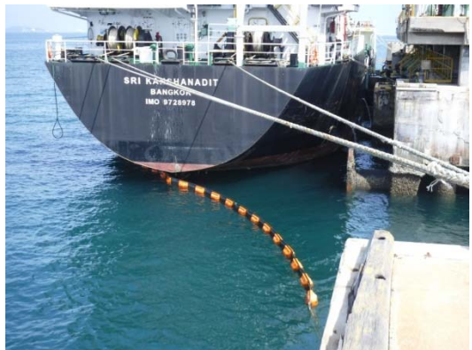
รูปที่ 38 การล่อมน้ำมันขณะสูบน้ำถ่ายผลิตภัณฑ์
